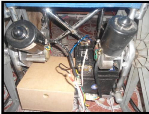
Fig.5. Acoplamiento de Motores y circuitos de activación a la silla de ruedas
