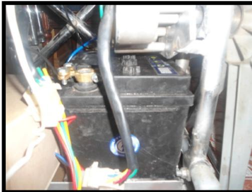
Fig.3. Acoplamiento de batería a la silla de ruedas
