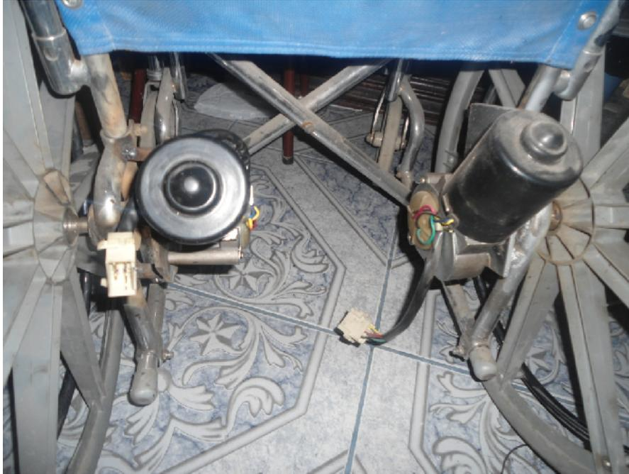
Figura IV. 31. Motores acoplados a la silla de ruedas
