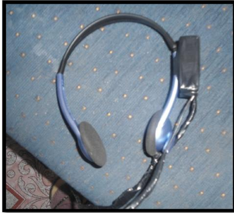
Fig.4. Acoplamiento Vrobot a audífonos de computadora
