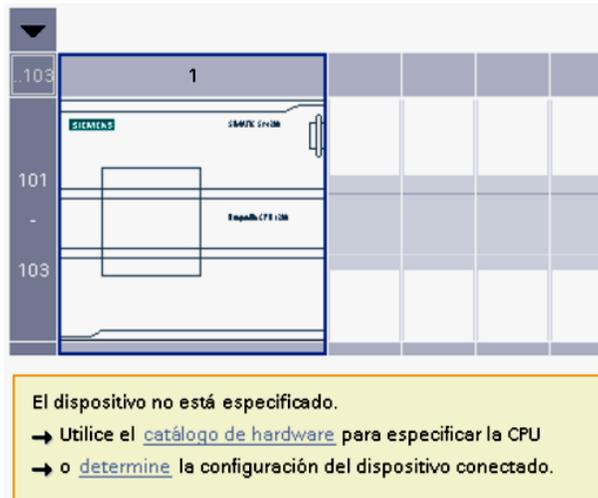
**Figura IV- 31: Detección del dispositivo conectado**
