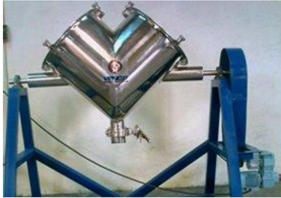
**Figura II- 5: Mezclador móvil Tipo V.**
