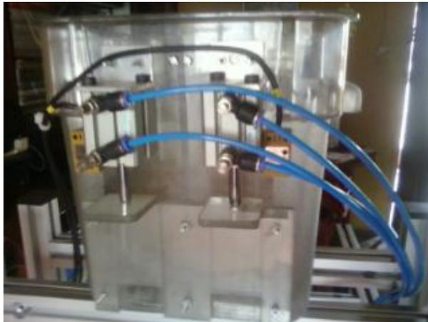
**Figura V- 3: Cilindros de Apertura y cierre de compuertas.**
