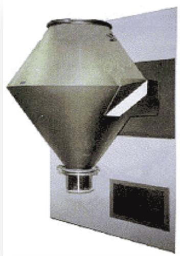
**Figura II-4: Mezclador móvil de doble cono.**
