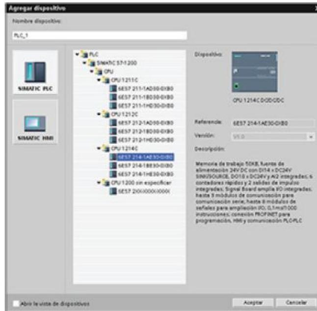
Figura IV- 281: Forma de insertar un dispositivo
