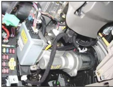
**Figura III-17: Motor eléctrico instalado en el HiundayAccent.**
