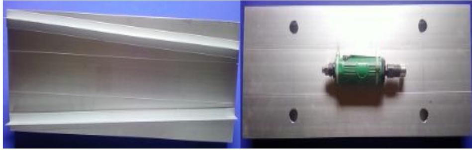
**Figura V- 4: Vibrador Neumático en la plancha de Aluminio.**
