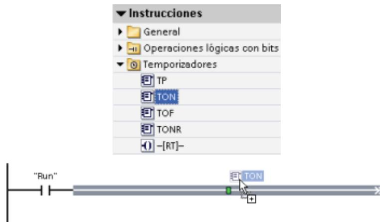
Figura V - 28: Introducir un temporizador al segmento.
