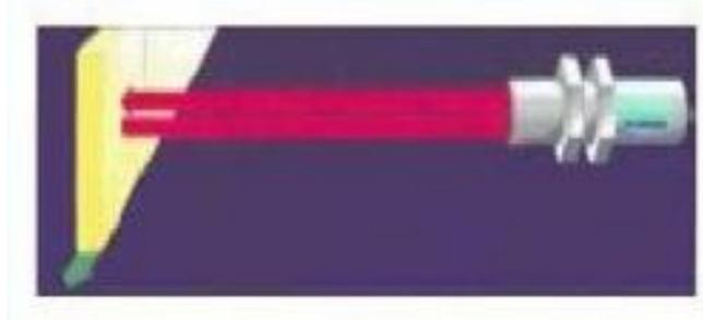
Figura III-27 Sensores Fotoeléctrico de barrera.
