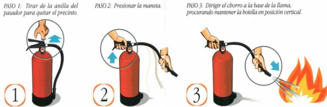
Figura 39. Instructivo de uso del extintor.
