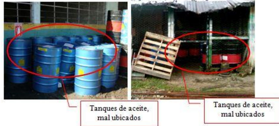
Figura 13. Mala ubicación de tanques
