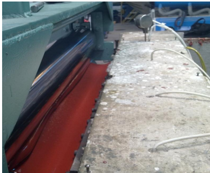
Figura III-39 Sistema de censado de temperaturas en el labio inyector
