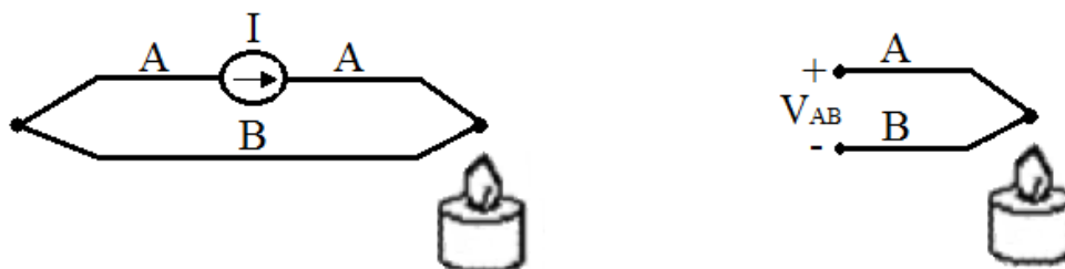
Figura II-9 Termopares formados por distintos metales
