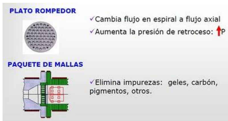
Figura II-23 Plato rompedor y mallas
