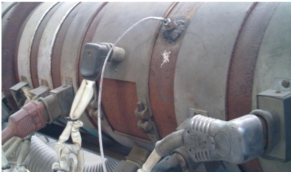
Figura III-38 Sistema de censado de temperaturas en el cañón
