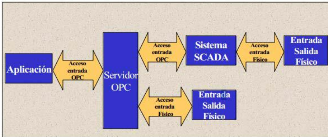
Figura II-15 Relación Cliente Servidor y Sistemas SCADA
