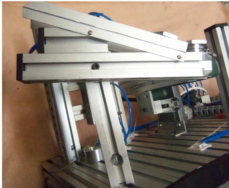
**Figura V.57.** Alimentador de Tapas con soporte para la base.
