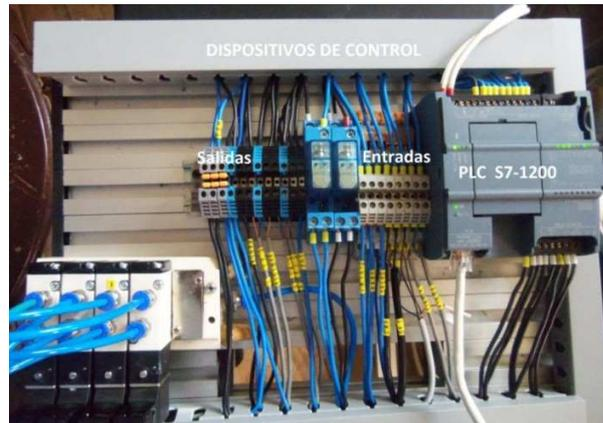
**Figura V.62.** Área de Control del módulo.
