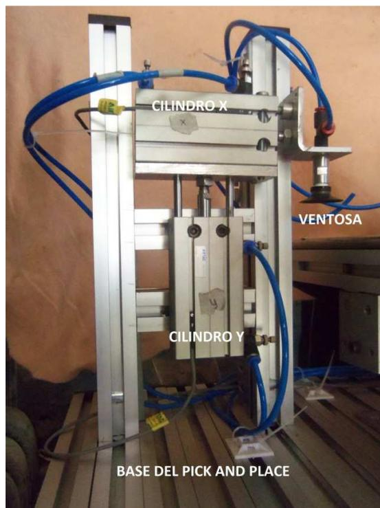
**Figura V.58.** Montaje estructural de la sección Pick and Place.
