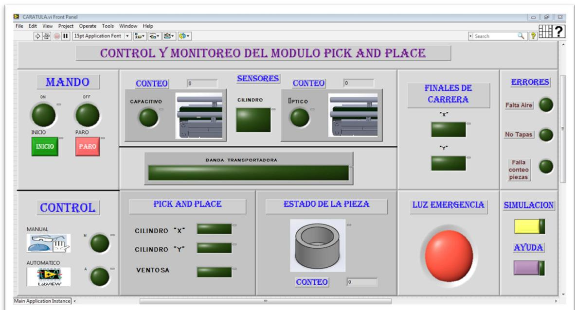
**Figura V.78.** HMI implementado en Labview.
