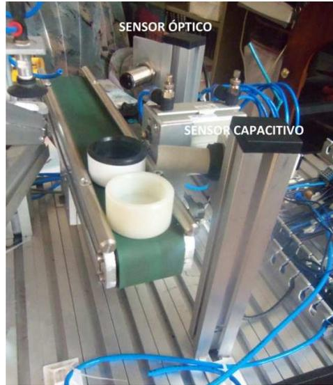
**Figura V.64.** Sensores Capacitivo y Óptico
