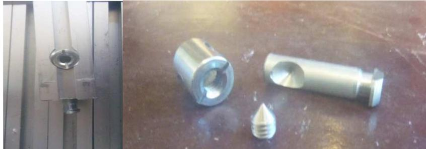
**Figura V.55.** Conectores de perfiles u ubicación en el perfil.
