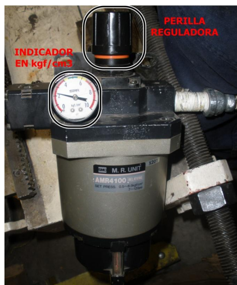
Figura III.42. Unidad de mantenimiento para aire comprimido
