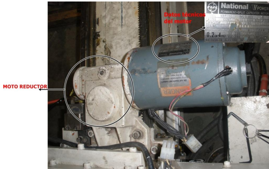
Figura II.7. Motor montado en el proyecto
