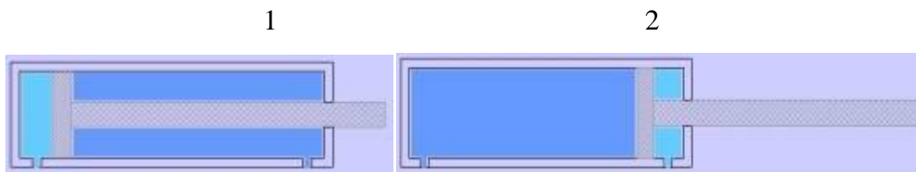
Figura II.13. Transiciones del cilindro de doble efecto
