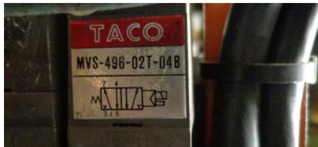
Figura II.17. Electroválvula 5/2 utilizada en proyecto
