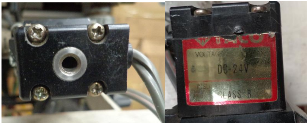
Figura II.15. Solenoide de la electroválvula utilizada en el proyecto
