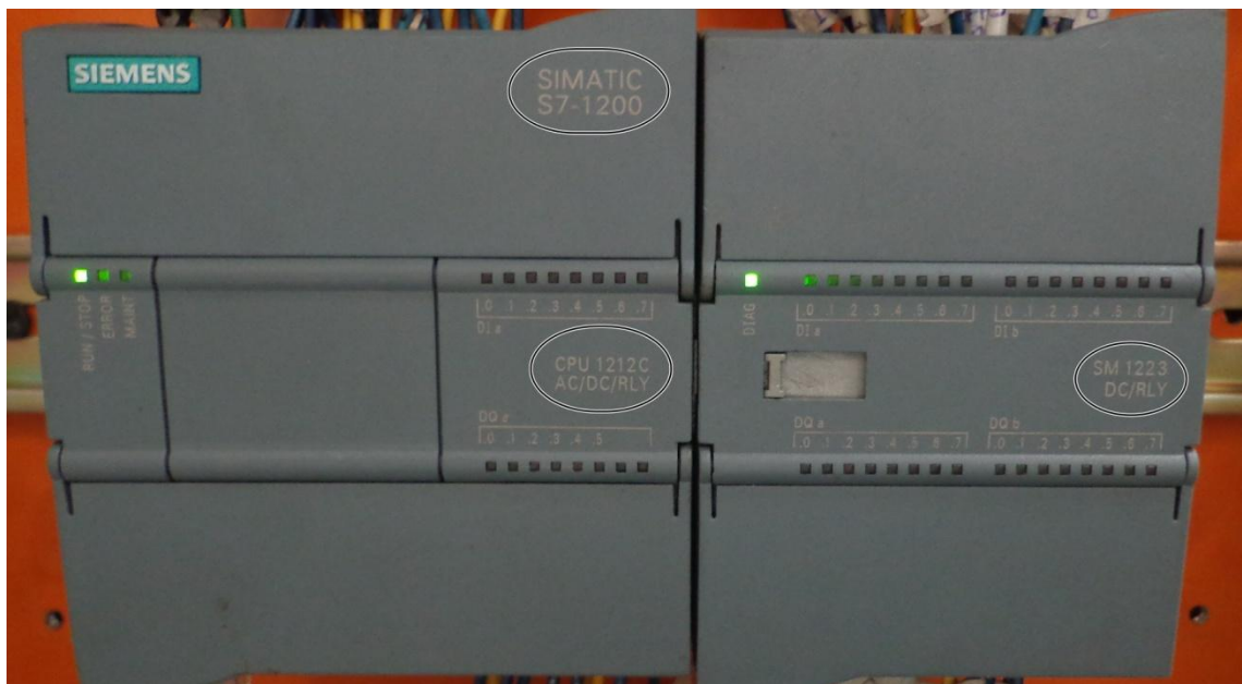
Figura III.58. PLC utilizado en el diseño
