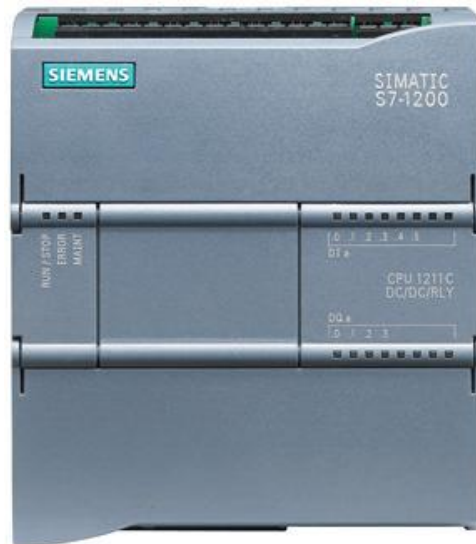
Figura II.26. Estructura externa del PLC S7-1200
