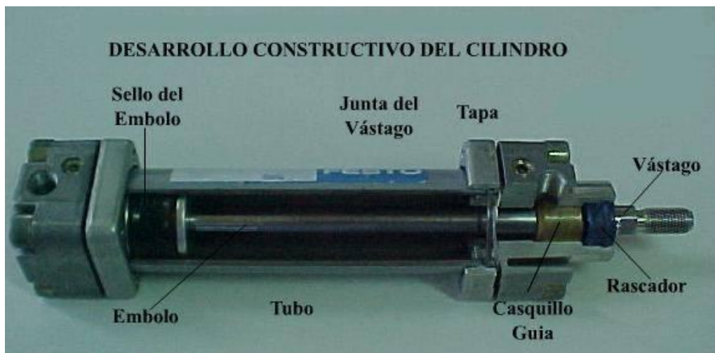
Figura II.11. Partes de un cilindro neumático
