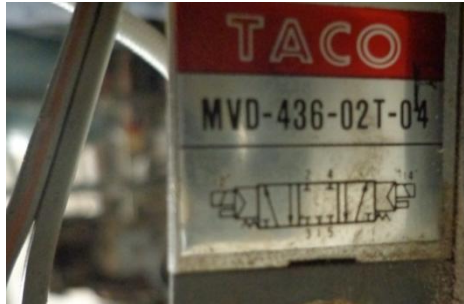
Figura II.18. Electroválvula 5/3 utilizada en proyecto
