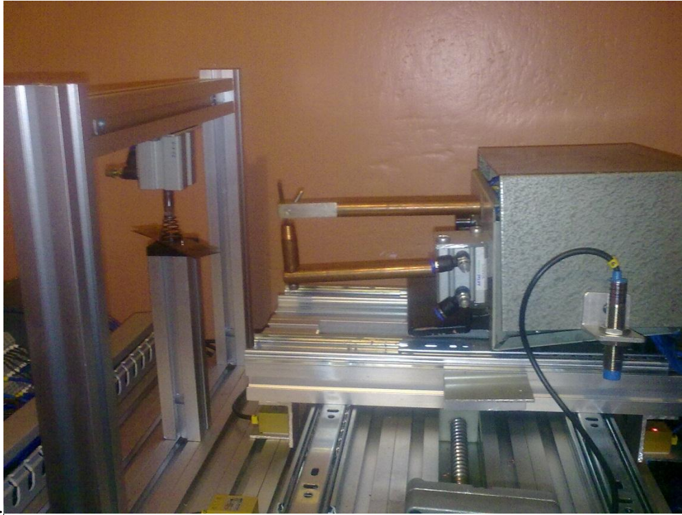
Figura. IV-11 Vista frontal del sistema de soldadura por punto
