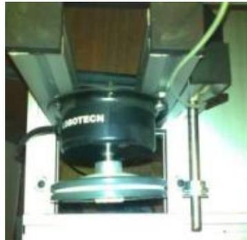
**Fig. II-8 Motor monofásico de baja velocidad**
