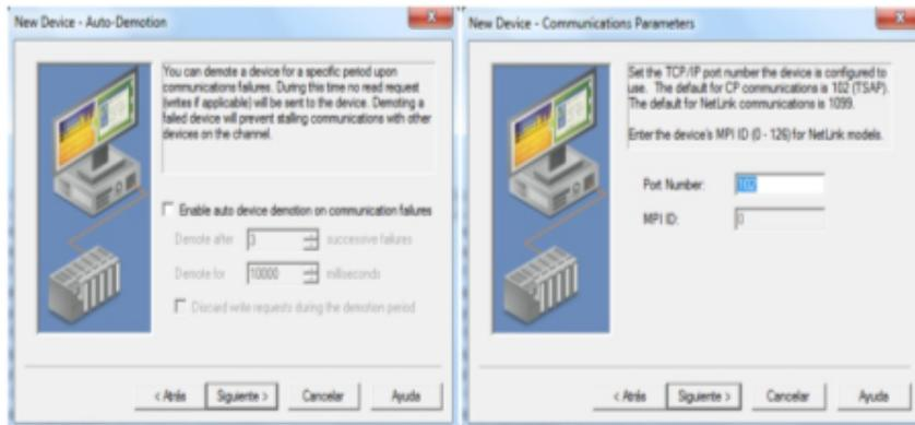
Fig. IV-31 Se establecen los parámetros de puerto de comunicación y modos de escritura.
