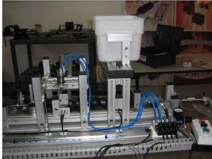
**Fig. III-12 Gusano transportador.**
