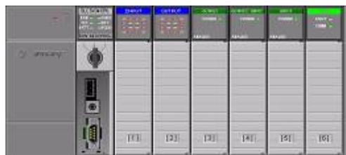
Fig. II-25 PLC de estructura modular
