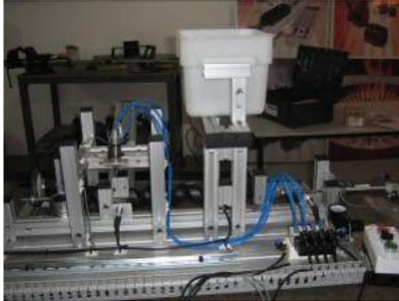
**Fig. III-3 Sistema de dosificación de recipientes.**
