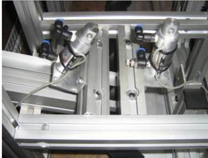
**Fig. III-6 Cilindros dosificadores**
