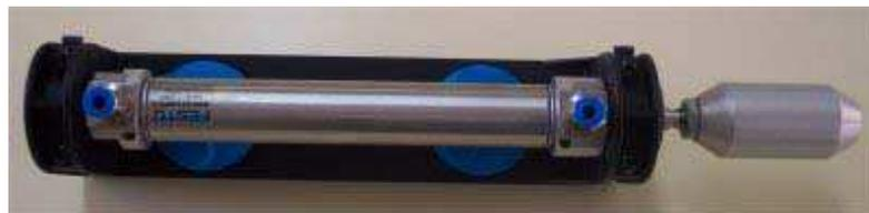
**Fig. II-16 Foto de un cilindro de doble efecto.**
