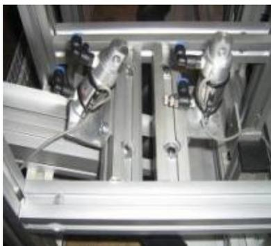
Los sensores magnéticos también se les denominan relés tipo “reed”, son utilizados en cilindros neumáticos para detectar la posición de fin de carrera a través del vástago.
