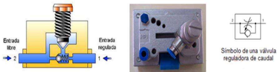
Fig. II-22 Válvulas reguladoras de caudal
