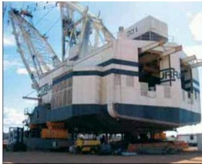
**Figura II-22.** Sistema Oleohidráulico para elevación pesada con precisión milimétrica
