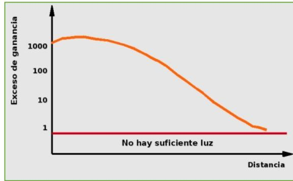
Figura II-32. Curva de ganancia de un sensor
