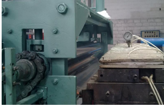
Figuralll-48. Labio laminador dispuesto de termocuplas en la parte superior Fuente: Los autores
