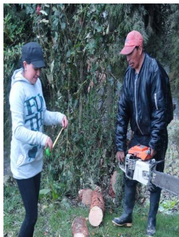
Medición y trozado (1m de longitud de la troza)
