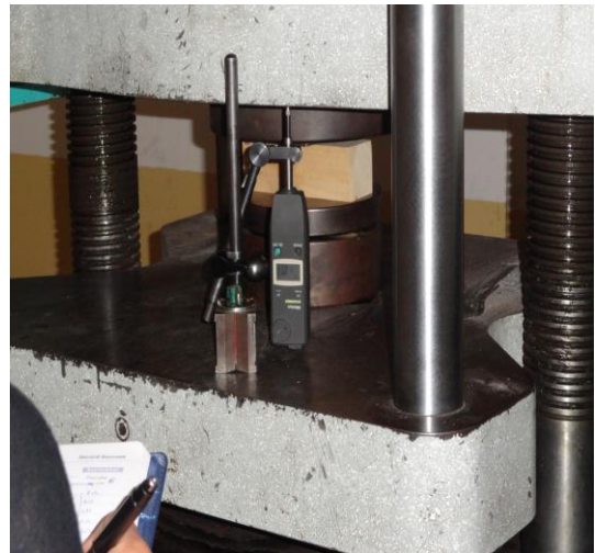
Deformimetro con apreciaciones de 0.01mm
