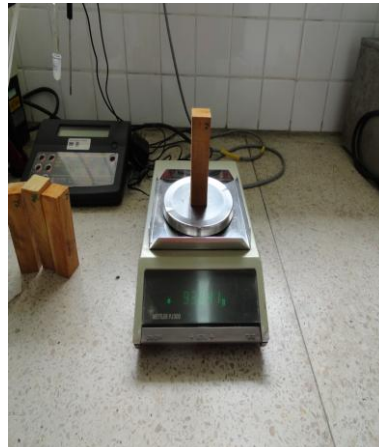
Peso de las probetas (3x3x10 cm y 3x3x2 cm)
