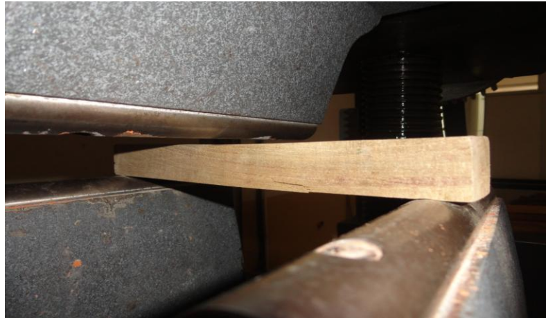
Aplicación de cargas en el centro de la probeta
