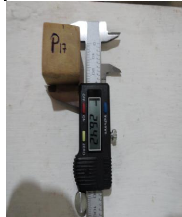
Medición de las probetas (3x3x10cm y 3x3x2 cm)
