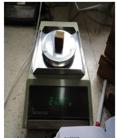
Medición de las probetas (3x3x10cm y 3x3x2 cm)
