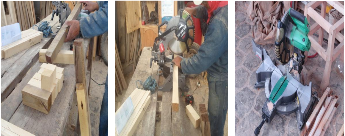
Elaboración de probetas para los ensayos de contenido de humedad, densidad, flexión, dureza, compresión paralela y perpendicular. (Inglateadora)
