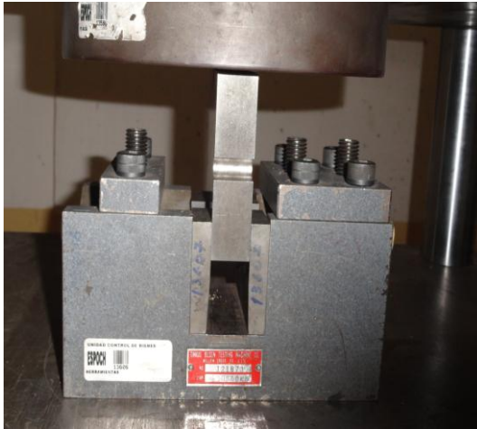
Cámara de corte y punzón
