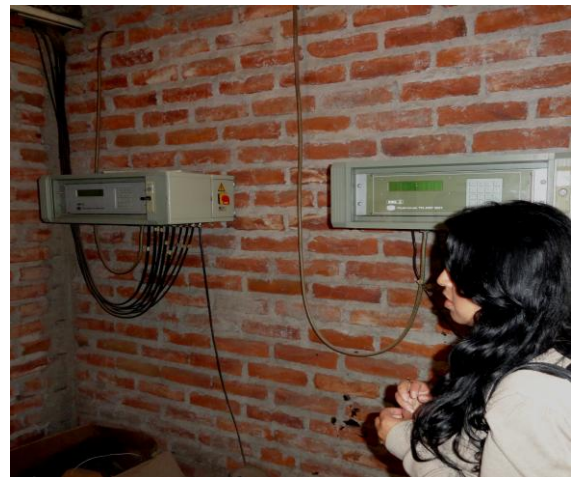
Control del porcentaje de humedad de las maderas
