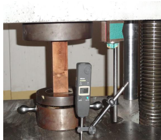
Deformimetro con apreciaciones de 0.01mm
