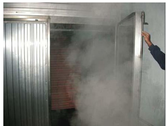
Secado de la madera en cámara controlada
