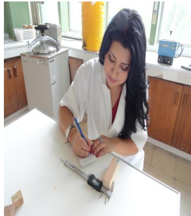
Medición de las probetas (3x3x10cm y 3x3x2 cm)
