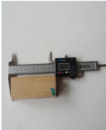
Medición de las probetas (3x3x10cm y 3x3x2 cm)
