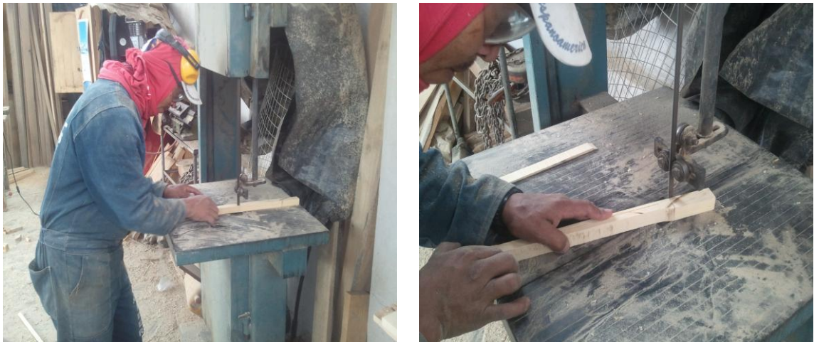
Elaboración de probetas para el ensayo de tracción (sierra)
