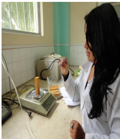
Medición de las probetas (3x3x10cm y 3x3x2 cm)
