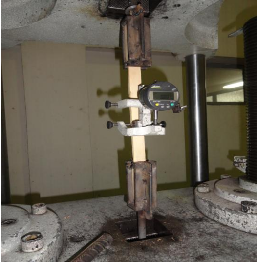
Mordazas de sujeción del tensómetro
