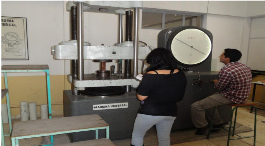
Aplicación de cargas y registro de datos
