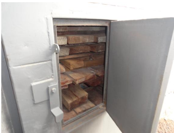
Secado de la madera en cámara controlada
