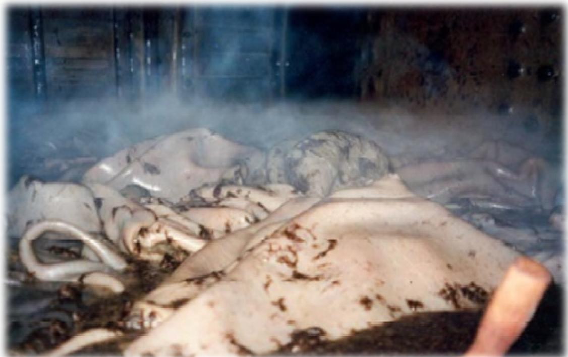
Fotografía 1. Vista del interior del bombo al final del proceso de pelambre no destructor de pelos.
