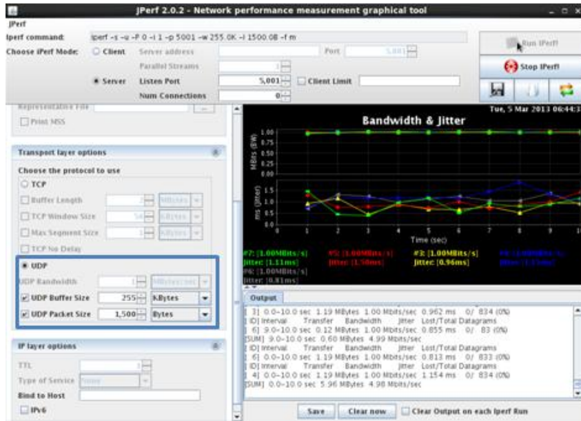
Gráfico IV. 50 Configuración de Jperf para medir Jitter
