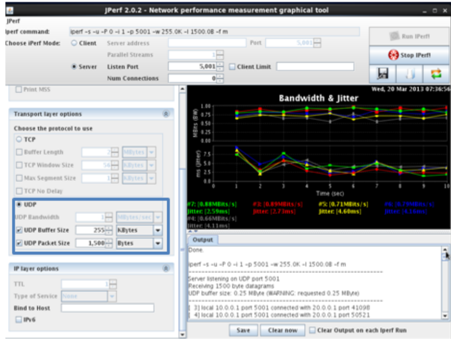
Gráfico VI. 73 Configuración de Jperf para medir Jitter
