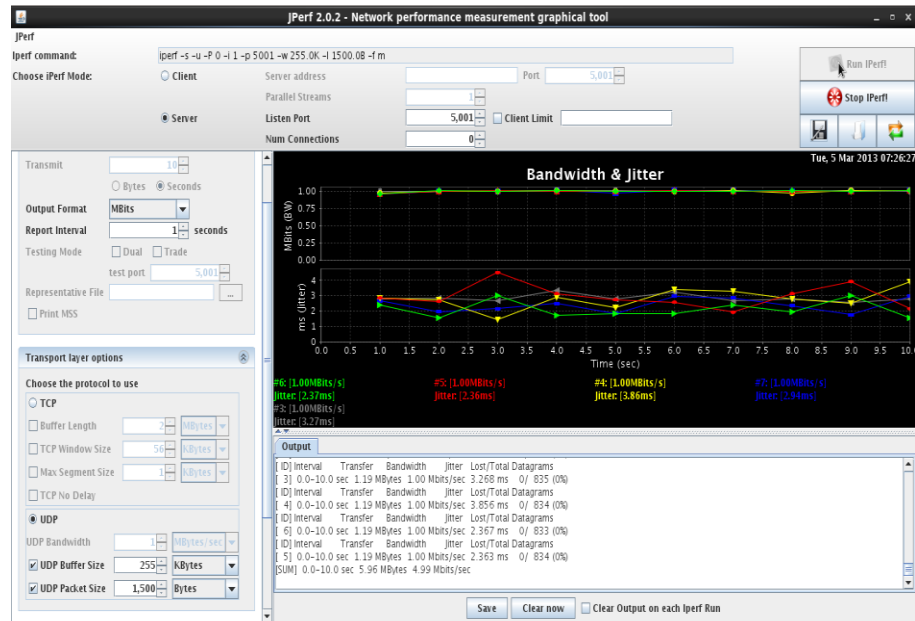
Gráfico VI. 79 Configuración de Jperf para medir Jitter
