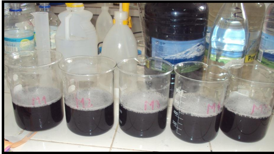
Foto 1. Muestra de Agua Residual de Lavandería y Tintorería JAV – TEX.
