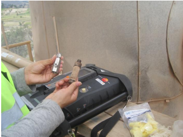
Foto N°9 Unión y Filtro-Sonda de Gases
