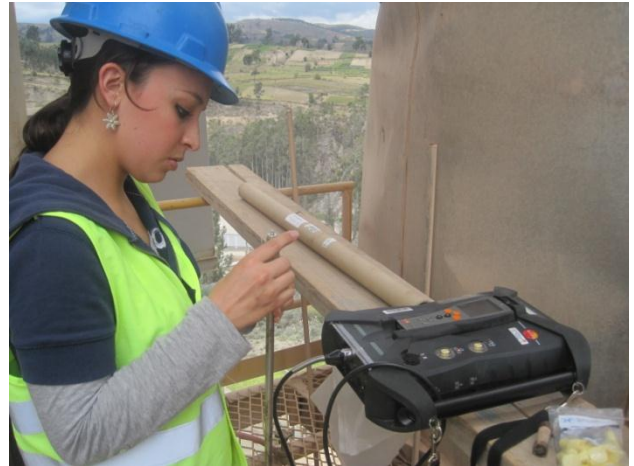
Foto N°10 Conexión TESTO 350-Sonda
