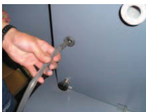
Figura 3.39 Retiro de la manguera del espectrómetro y de la botella.
