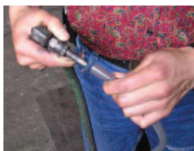
Figura 3.40 Limpieza del interior de la manguera.
