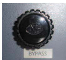
Figura 3.34 Regulador de flujo de gas argón en bypass.
