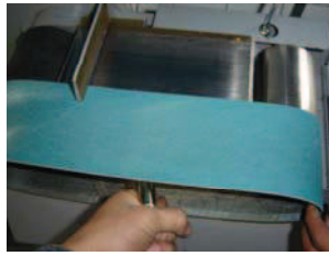
Figura 3.59 Cambio de lija nueva.
