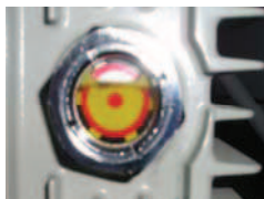
Figura 3.38 Indicador del nivel de aceite.
