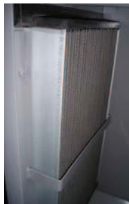
Figura 3.63 Filtro de limalla
