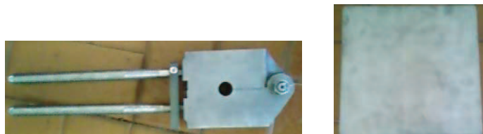
Figuras 3.2 Molde y base metálica.
