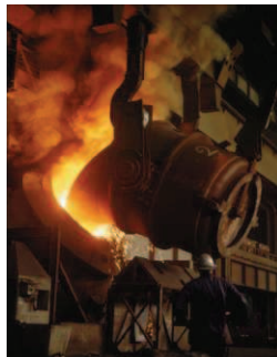
Figura 2.1 Colado del Acero 1
