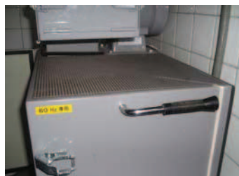
Figura 3.61 Manija agitadora del filtro.
