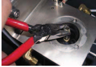
Figura 3.50 Extracción del electrodo.
