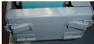
Figura 3.57 Ganchos de anclaje de las tapas.
