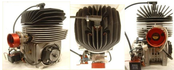
Figura 71.Motor seleccionado para nuestro kart (Komet)
