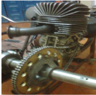
Figura 204. Montaje del sistema de escape, sistema de encendido y sistema de transmisión.
