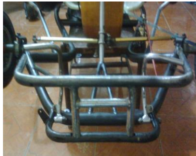
Figura 224. Colocación de los guardachoques del kart
