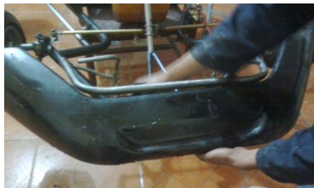
Figura 225. Colocación de los protectores plásticos
