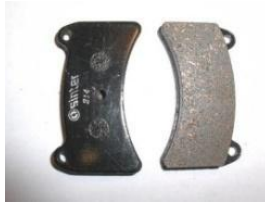
Figura 83. Pastilla de frenos del kart
