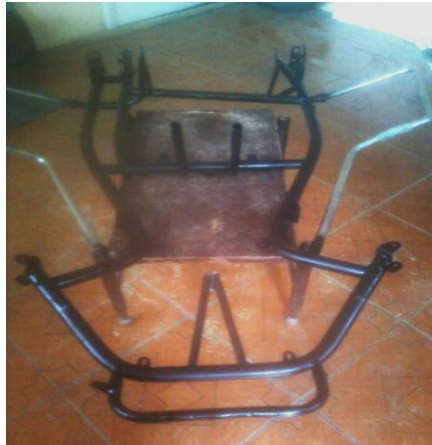
Figura 187. Chasis terminado vista superior
