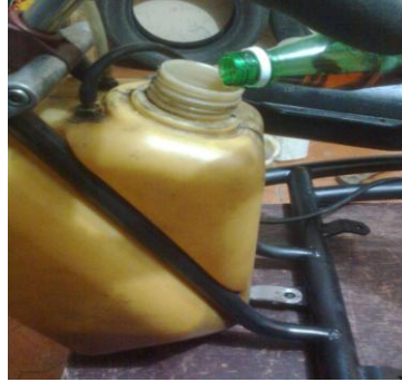
Figura 208.Colocación de mezcla al motor
