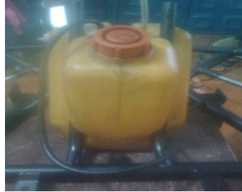
Figura 218.Montaje del tanque de combustible
