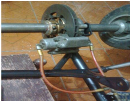
Figura 212. Instalación de la mordaza cañerías y disco de frenos
