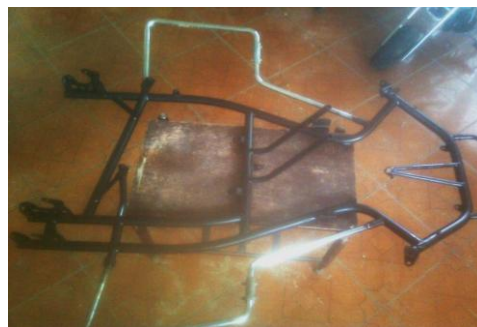
Figura 186.Chasis terminado vista lateral
