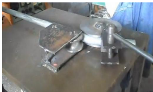
Figura 170. Doblaje de tubos Interiores
