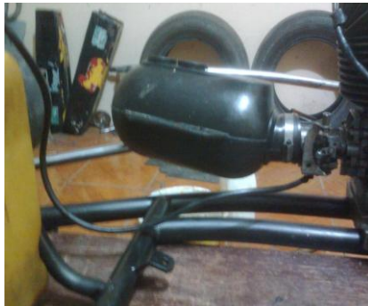
Figura 206.Colocación del conducto de alimentación principal de la mezcla
