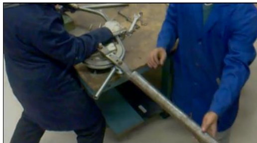
Figura 167. Doblaje de tubos parte frontal
