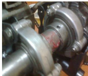
Figura 209.Lubricación y colocación del eje posterior
