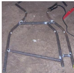
Figura 183. Soldadura del tubo diagonal al chasis cuadro.
