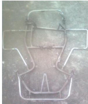
Figura 184.Montaje de los tubos parachoques.
