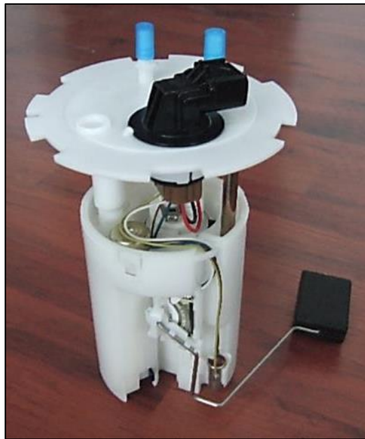
Figura 30. Bomba de combustible
