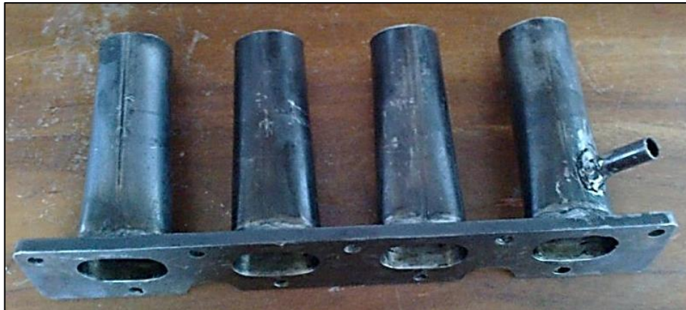
Figura 41. Múltiple de admisión diseñado
