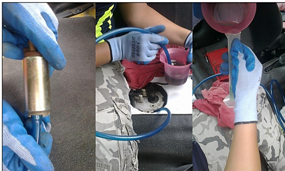
Figura 73. Instalación del equipo para la prueba de consumo
