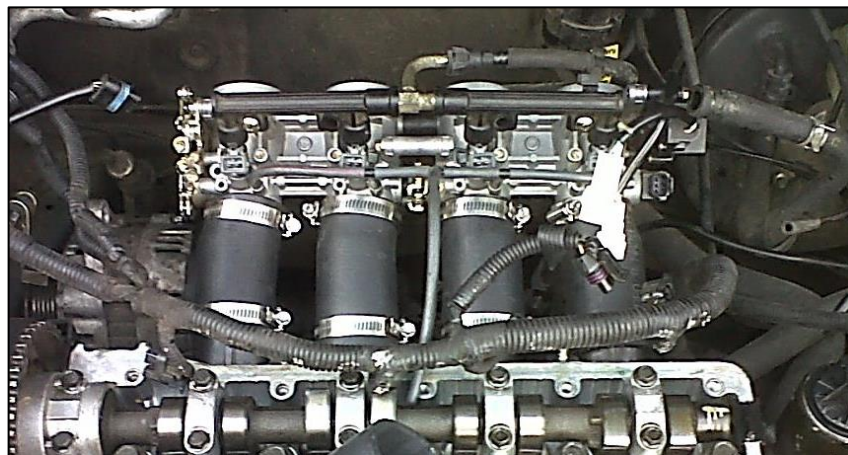
Figura 44. Montaje del múltiple de admisión diseñado
