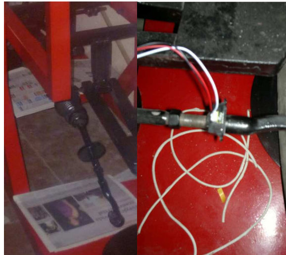
Figura 143. Ubicación del sensor para medir la convergencia y divergencia
