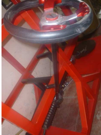
Figura 127. Acoplamiento del volante
