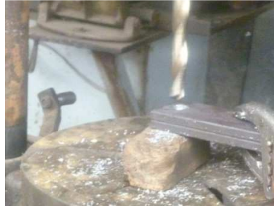
Figura 118. Taladrado de las platinas de la barra de torsión
