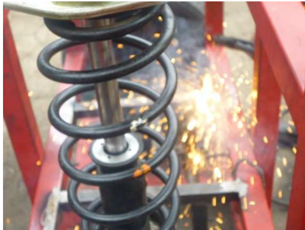
Figura 121. Soldadura de travesaños para el montaje de la barra de la dirección
