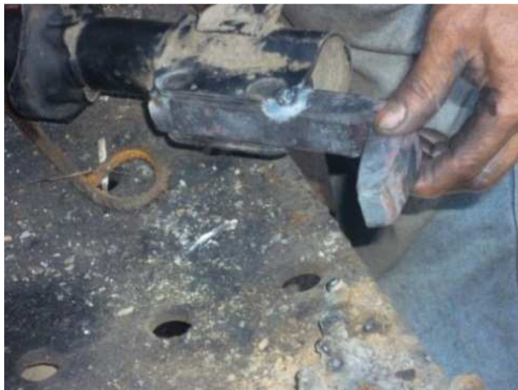
Figura 103. Soldadura de la pieza en L al amortiguador
