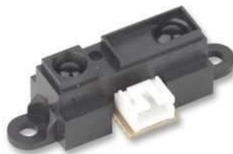
Figura 142. Sensor de distancia por infrarrojos GP2D120XJ00F
