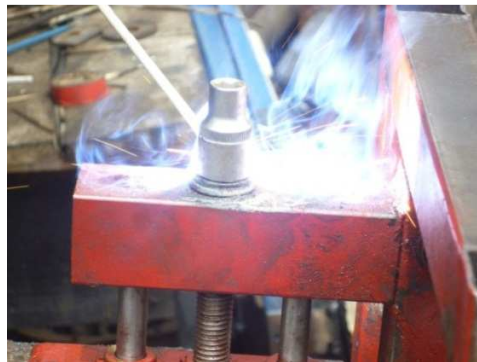
Figura 57. Soldadura de una copa # 10 para el acoplamiento de los motores
