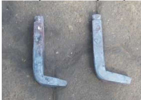
Figura 102. Material de adaptación de la mangueta forjado a una forma en L
