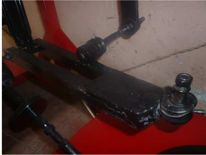
Figura 120. Montaje de la barra de torsión al sistema de suspensión
