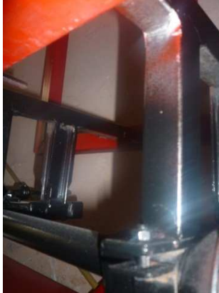
Figura 122. Colgantes para el montaje y sujeción de la barra de dirección
