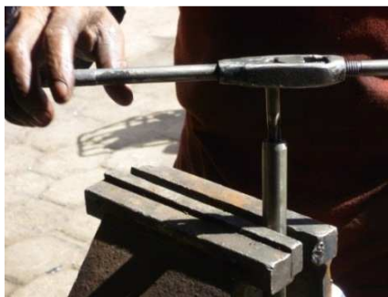
Figura 135. Machuelado del eje de deslizamiento de los motores del camber
