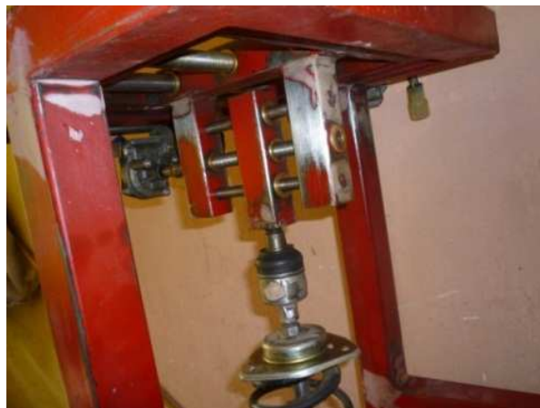
Figura 108. Acoplamiento del muñón para minimizar los efectos de modificación de la geometría de dirección
