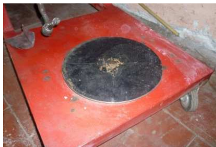
Figura 94. Acoplamiento de los discos giratorios a la estructura
