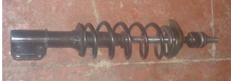
Figura 107. Conjunto amortiguador, muelle y torreta McPherson
