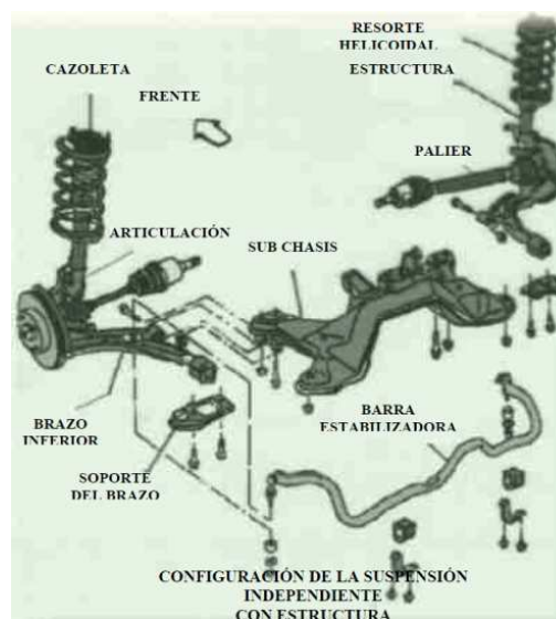
Figura 23. Sistema de suspensión de semiejes oscilantes
