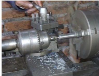
Figura 134. Operación de taladrado del eje de deslizamiento
