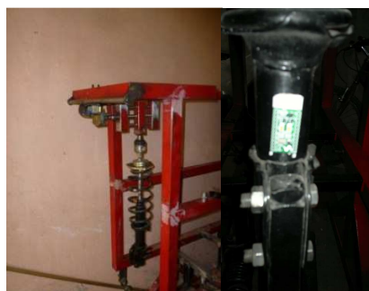
Figura 139. Ubicación del sensor encargado de apreciar la variación del camber
