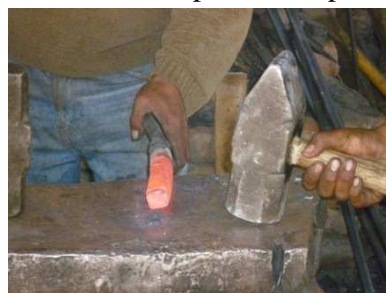
Figura 101. Forjado del material para la adaptación de la mangueta
