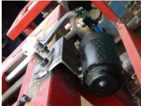
Figura 132. Motor encargado de modificar el caster, acoplado al banco
