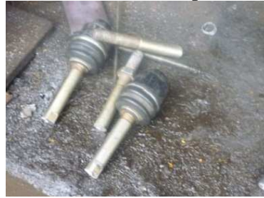
Figura 115. Barras de torsión cortadas para aumentar su longitud
