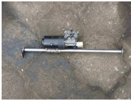
Figura 136. Disposición del montaje del motor encargado de modificar el camber
