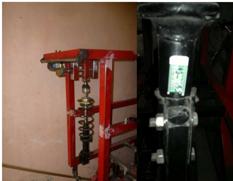
Figura 140. Ubicación del sensor encargado de apreciar la variación del caster
