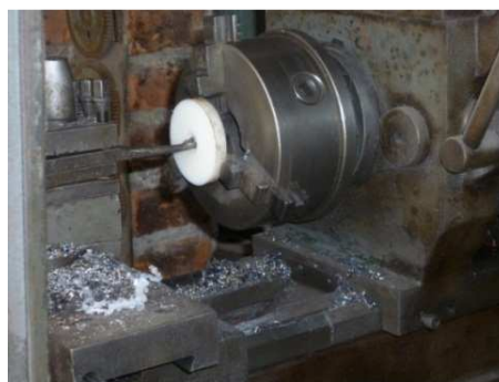
Figura 144. Rueda de teflón para el sensor de distancia por infrarrojos
