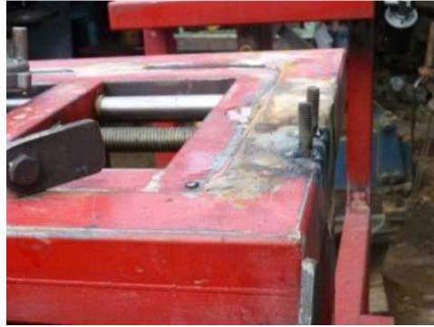
Figura 131. Soldadura de los pernos para la sujeción del motor del caster
