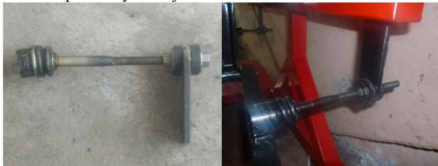
Figura 119. Disposición y montaje de la barra de torsión a la estructura del banco
