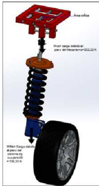
Figura 65. Cargas en el tornillo y área crítica
