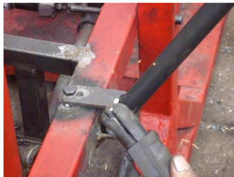
Figura 126. Acoplamiento de la columna de dirección
