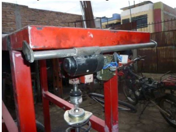
Figura 137. Montaje del motor encargado de modificar el camber
