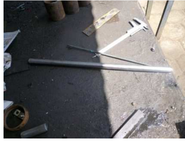
Figura 133. Eje de acoplamiento de los motores encargados del camber
