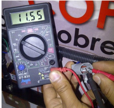
Figura 129. Comprobación de voltaje bobinas COP
