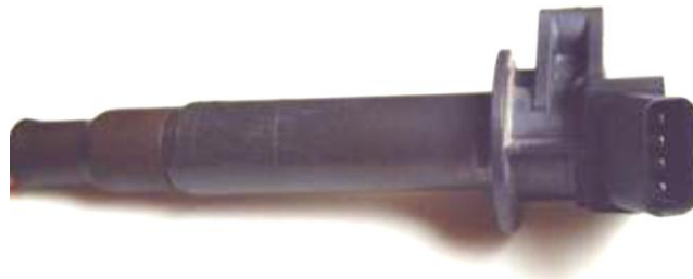
Figura 86. Bobina COP con modulo incorporado
