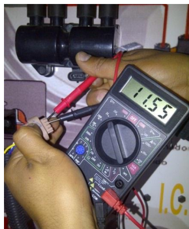
Figura 132. Comprobación de voltaje
