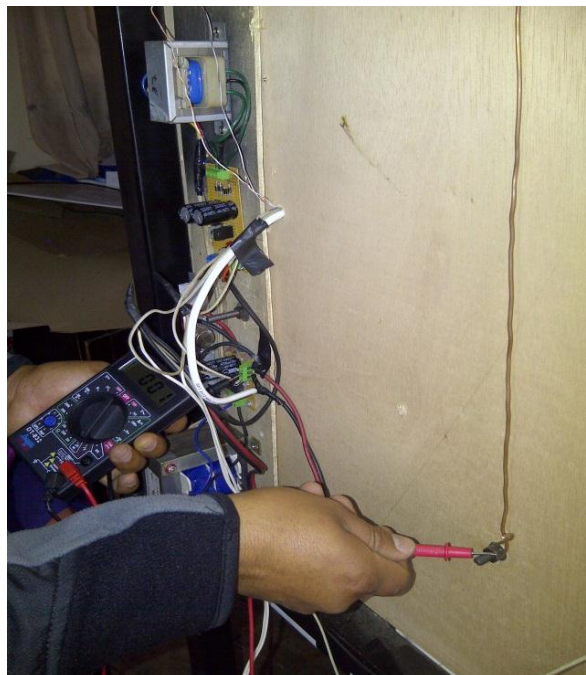
Figura 124. Comprobación de continuidad
