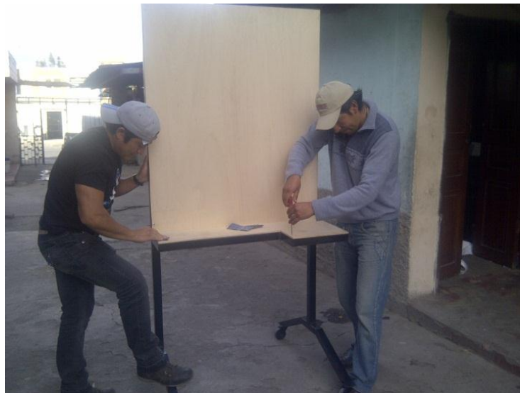
Figura 100. Colocación de planchas de madera
