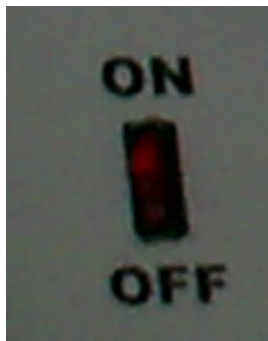
Figura 108. Switch de encendido
