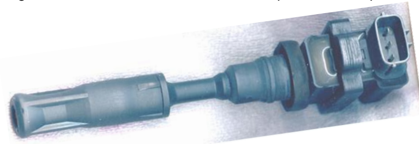
Figura 83. Bobina COP con transistor de potencia incorporado
