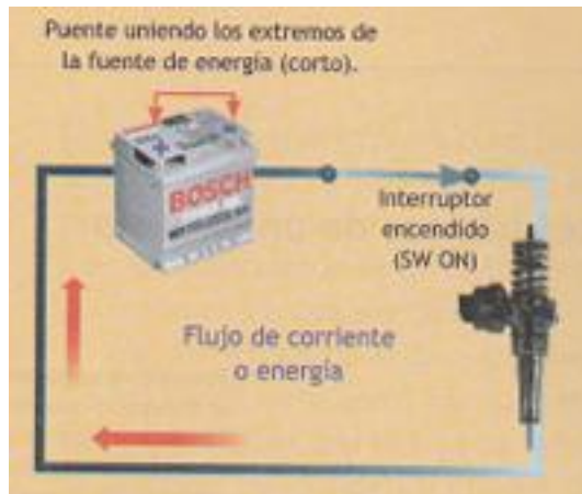
Figura 47. Circuito en corto.
