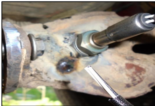
Figura 48. Sensor de oxígeno montado en el tubo de escape
