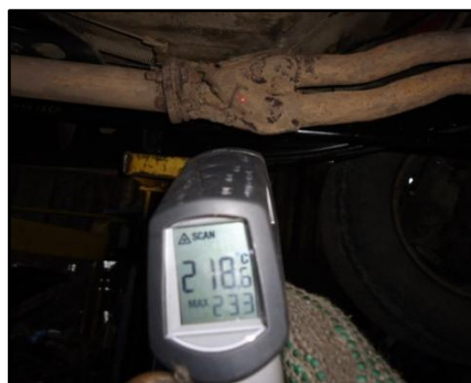
Figura 46. Determinación del punto más caliente en el escape
