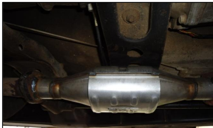
Figura 57. Catalizador montado en el tubo de escape
