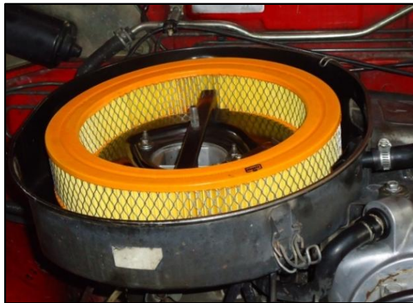
Figura 43. Cambio de filtro de aire
