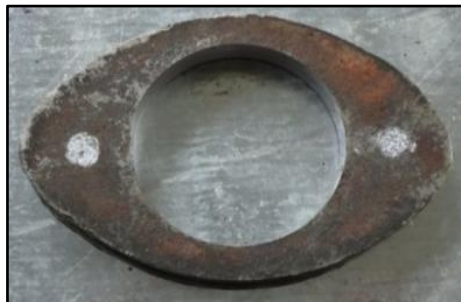
Figura 56. Brida para sostener el catalizador
