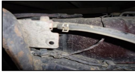
Figura 53. Toma de vapores de HC desde el tanque de combustible
