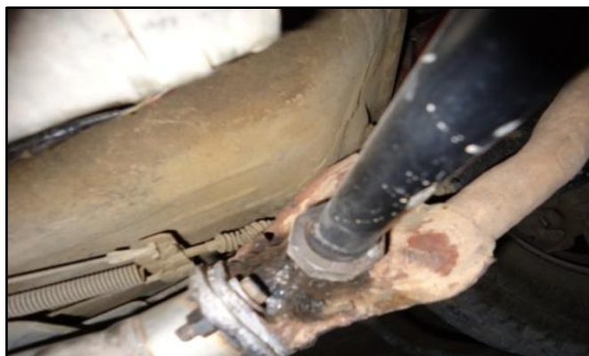
Figura 52. Tubo para toma de gases de escape
