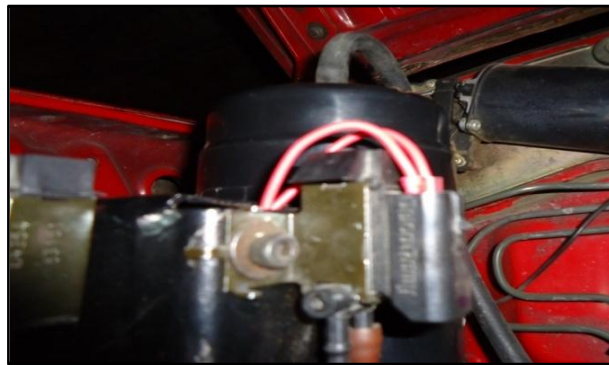
Figura 54. Instalación del solenoide del sistema EVAP
