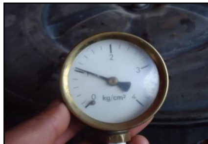
Figura 49. Medición de vacío en el carburador
