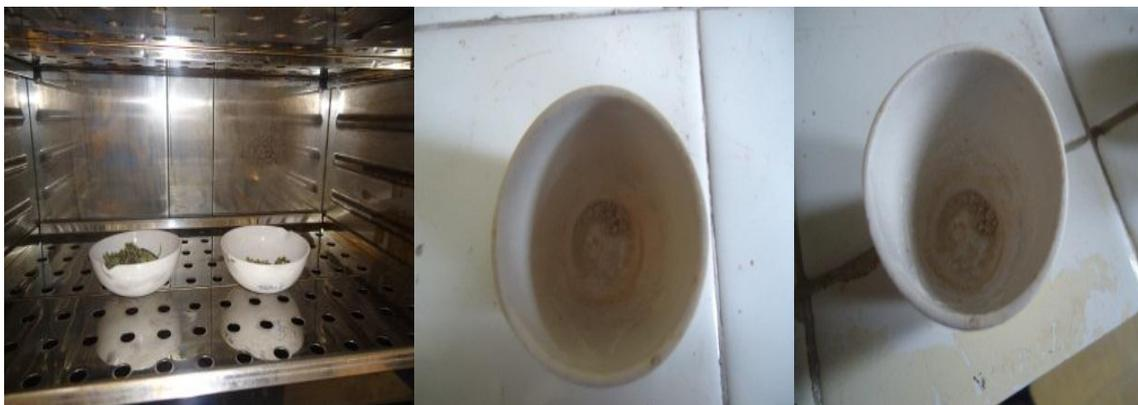
**FOTOGRAFÍA No. 3 DETERMINACIÓN DE HUMEDAD, CENIZAS TOTALES, CENIZAS SOLUBLES EN AGUA Y CENIZAS INSOLUBLES EN ÁCIDO CLORHÍDRICO DEL DIENTE DE LEÓN (*Taraxacum officinale*). LABORATORIO DE FITOQUÍMICA. FACULTAD DE CIENCIAS. ESPOCH. MARZO 2012.**
