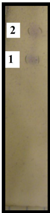
FOTOGRAFÍA N° 1: CROMATOGRAFÍA EN CAPA FINA.SISTEMA DE SOLVENTES ÉTER-HEXANO (1:1) V/V REVELADOR VAINILLINA ÁCIDO SULFÚRICO.FACULTAD DE CIENCIAS. ESPOCH.JULIO 2012
