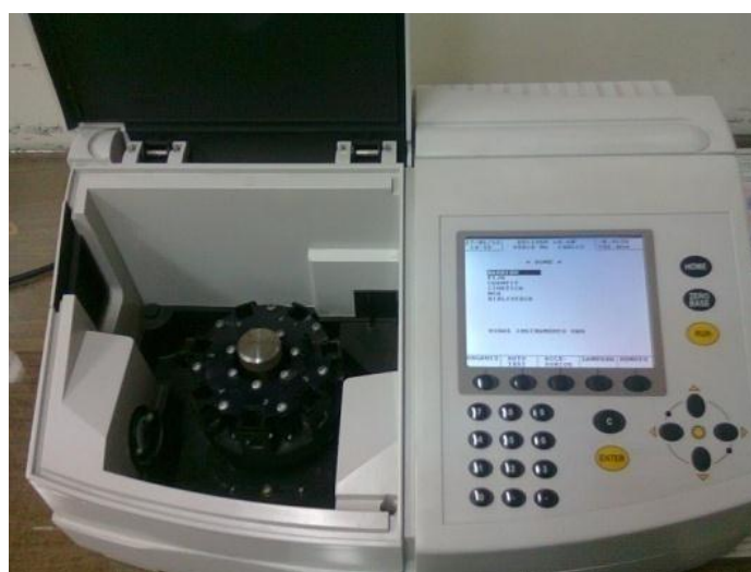
FOTOGRAFÍA No 6. ESPECTROFOTÓMETRO UTILIZADO PARA CUANTIFICACION DE CINAMATOS Y FLAVONOIDES
