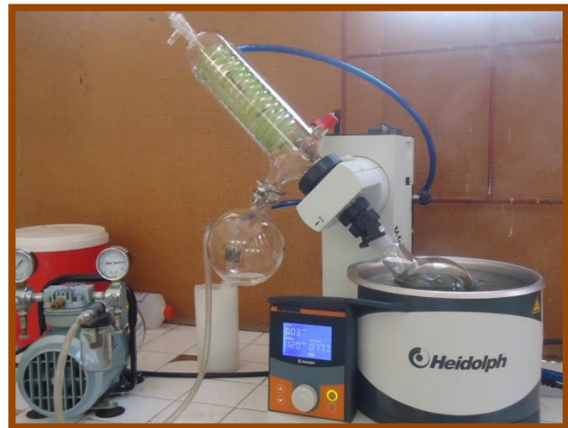
FOTOGRAFIA N° 11. CONCENTRACIÓN EN ROTAVAPOR
