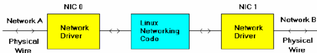
FIGURA XVIII.20 Diagrama de Bloques de un Computador con dos tarjetas de Red
