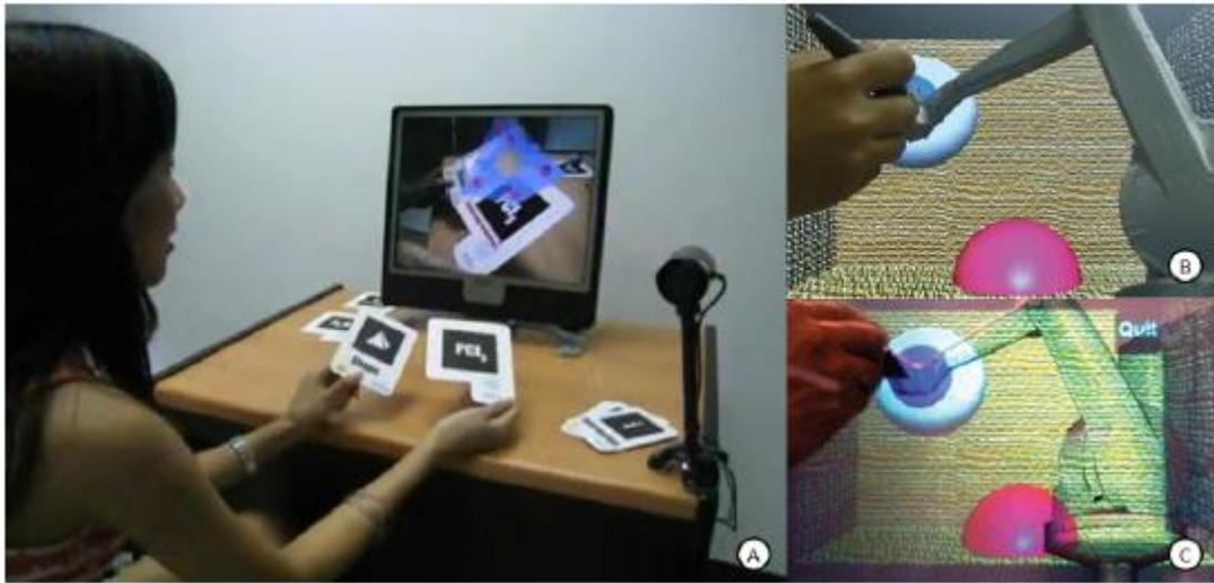
**FIGURA II. 18** - Ejemplos de Spatial Augmented Reality displays: **(A)** Uso de un monitor de escritorio; **(B)** Sistema que incluye dispositivo háptico para manipular objetos; **(C)** El mismo sistema pero ahora los objetos virtuales son desplegados sobre este gracias a un proyector.
