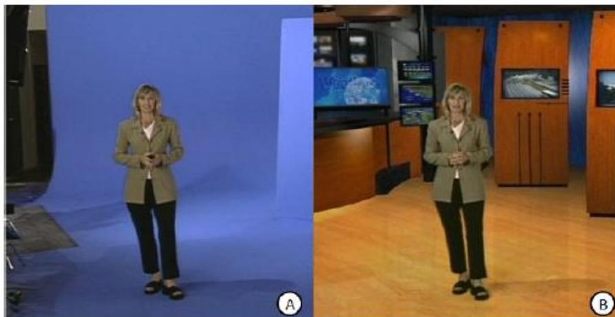
**FIGURA II. 2** - Ejemplo de Virtualidad Aumentada: **(A)** Conductora del programa posa delante de un fondo azul; **(B)** Resultado que es transmitido por televisión.
