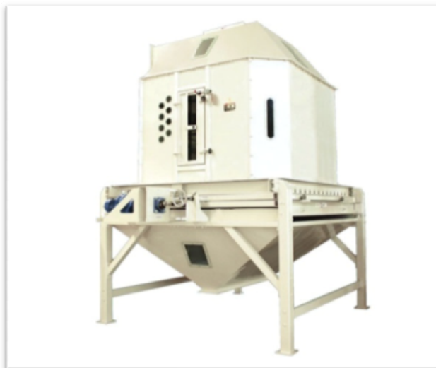
Fig. 1.1.5-1 Enfriador de Contraflujo (Cortesía de Alimentosa)
