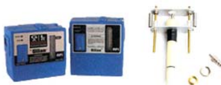
Fig. 2.3.2.2-2. Dosímetro de Polvo Respirable
