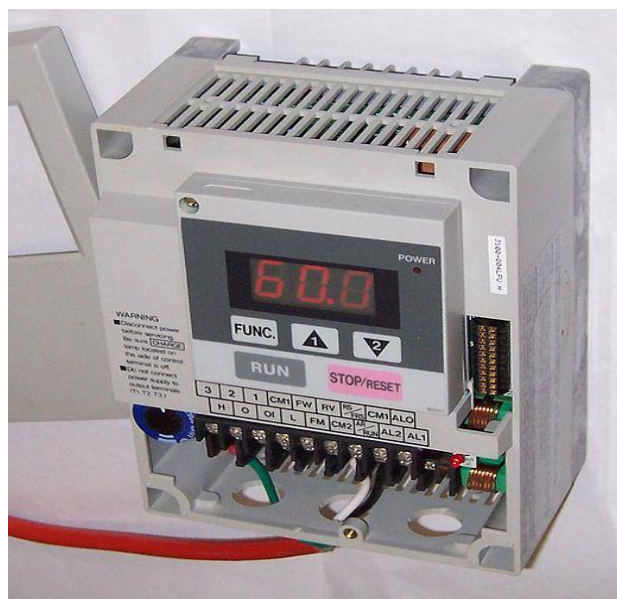
FIG. 1.2.5.5-1 VARIADOR DE FRECUENCIA
