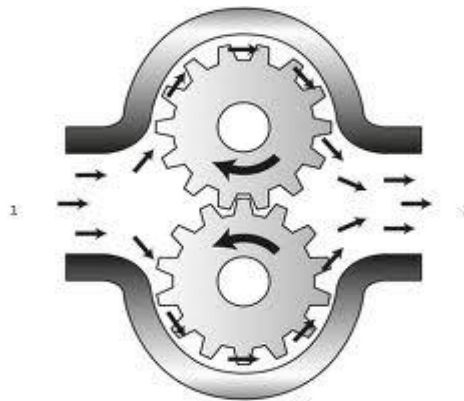
Fig. 1.3.1.9.1-1 Bomba Rotatoria
