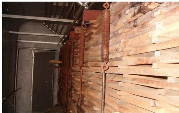
Fig. 1.2.6.-1. Prensas utilizadas para reducir los defectos en los procesos de secado.
