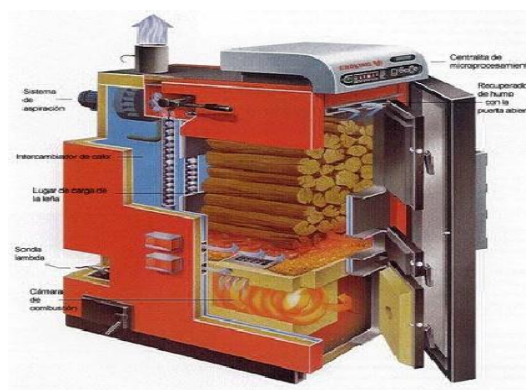
Fig. 1.1.14.1-1. Caldera de leña moderna de llama invertida.
