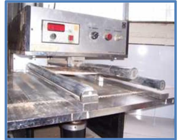
Utilizando una máquina para ensayos de resistencia de materiales, provista con dos apoyos paralelos cuya distancia es regulable, se determina MOR
