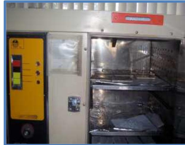
Introducir en la estufa las probetas, donde se mantiene a  $103^{\circ}\text{C} \pm 2^{\circ}\text{C}$ , pesar nuevamente para obtener la masa final
