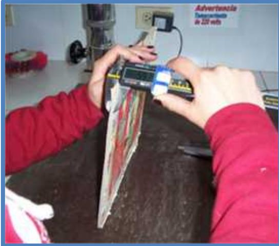
El espesor se mide en los cuatro puntos del eje transversal sobre el que se ha de aplicar la carga.
