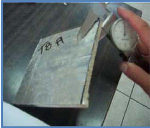
Se mide el espesor en los cuatro puntos; la media aritmética de las cuatro medidas se considerará como espesor efectivo de la muestra.
