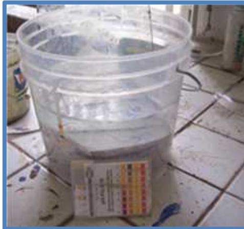
Se sumergen las muestras en el recipiente que contenga agua limpia y su temperatura sea de  $20 \pm 1^\circ\text{C}$ , se comprobará que el pH del agua sea de  $6 \pm 1$
