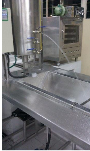
Fotografía 2.3.1.4-1 Proceso de Descarga de Líquidos por orificios
