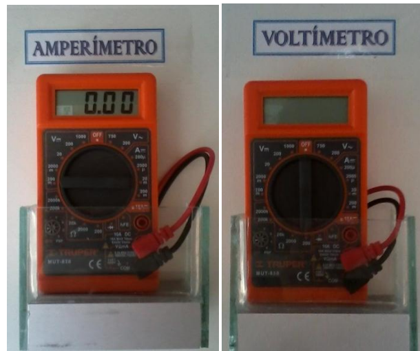
Foto 8 Amperímetro y voltímetro usados en la planta piloto
