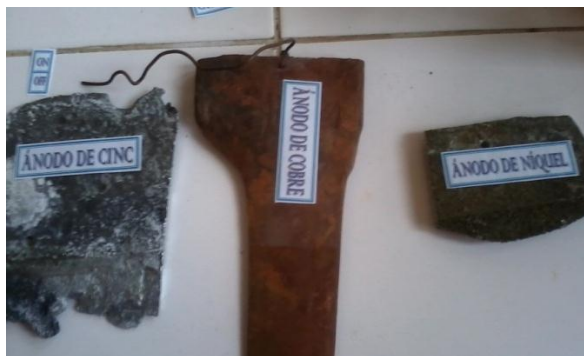
Foto 5 Ánodos usados en la planta piloto
