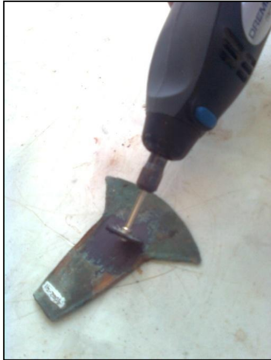
Foto 3: Muestra pulida para retirar el oxido
