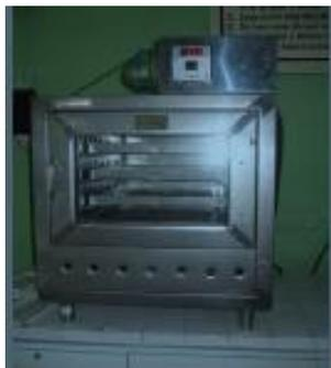
FOTOGRAFÍA N° 1 SECADOR DE BANDEJAS
