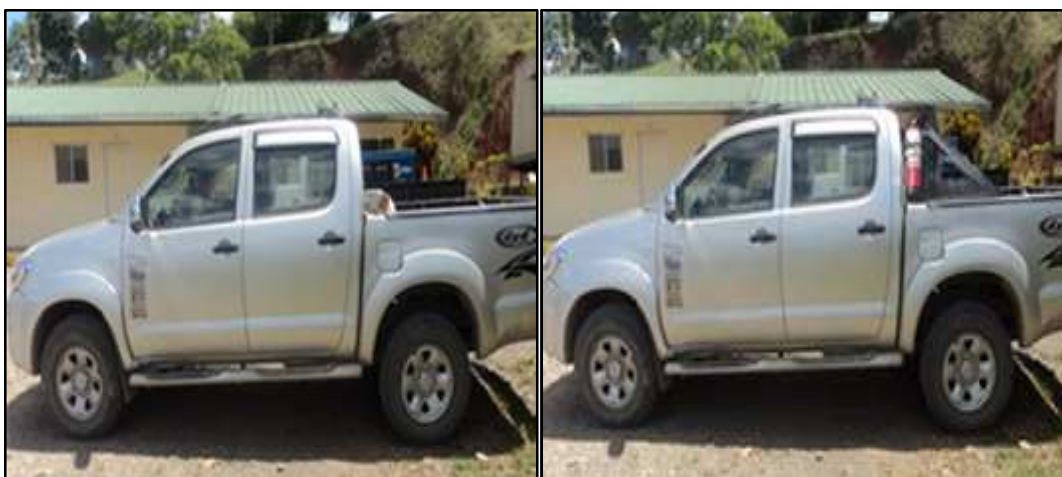
Figura 38. Implementación de soporte para extintor
