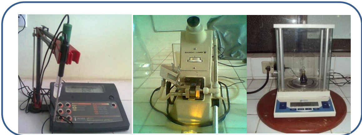
FOTOGRAFÍA N o . 11 EQUIPOS UTILIZADOS EN LA DETERMINACIÓN DE pH, ÍNDICE DE REFRACCIÓN Y DENSIDAD.
