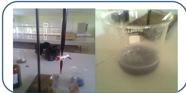
FOTOGRAFÍA N.º 19 DETERMINACIÓN DE VITAMINA C. MÉTODO DEL YODO
