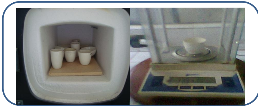
FOTOGRAFÍA N o . 5 DETERMINACIÓN DE CENIZAS TOTALES SOLUBLES E INSOLUBLES DE LA DROGA VEGETAL SECA Y MOLIDA
