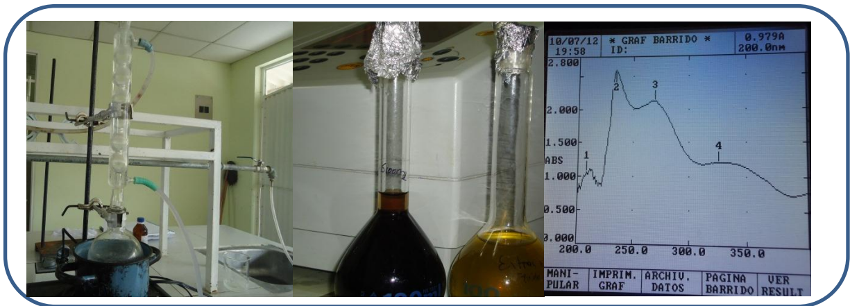
FOTOGRAFÍA N o . 12 CUANTIFICACIÓN DE FLAVONOIDES TOTALES A PARTIR DE LA MATERIA PRIMA
