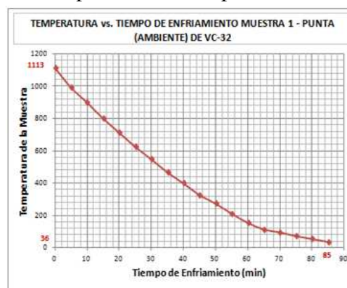
Figura 49. Perfil, temperatura vs tiempo de enfriamiento de VC32
