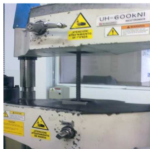
Figura 26. Montaje de la probeta en maquina universal
