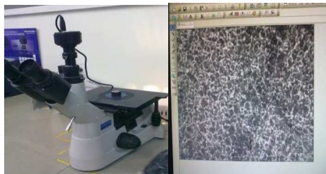
Figura 20. Micro-estructura de la probeta tomada en aumento de 100X
