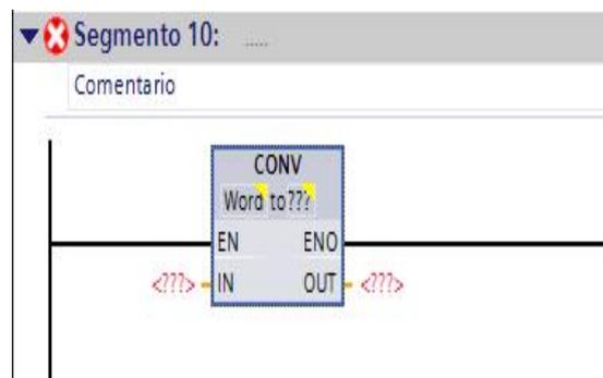
Figura IV. 77. **Tipo de dato Word configurado**
