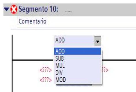
Figura IV. 82. Configuración del tipo de operación matemática
