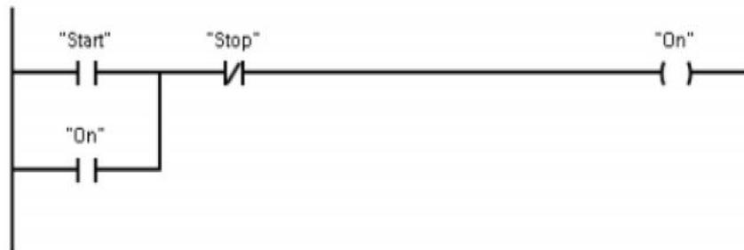
Figura III. 32. **Ejemplo de Esquema de Contactos**
