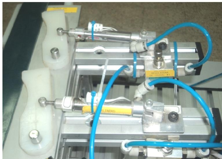
Los sensores ópticos e inductivos detectan el color y el material de las piezas. Los cilindros de carrera corta detienen la pieza en el transportador y la pasan para clasificación a una de las dos rampas. [38]
