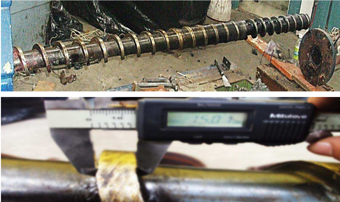
Figura 62. Limpieza y medición del diámetro y hélices del tornillo extrusor
