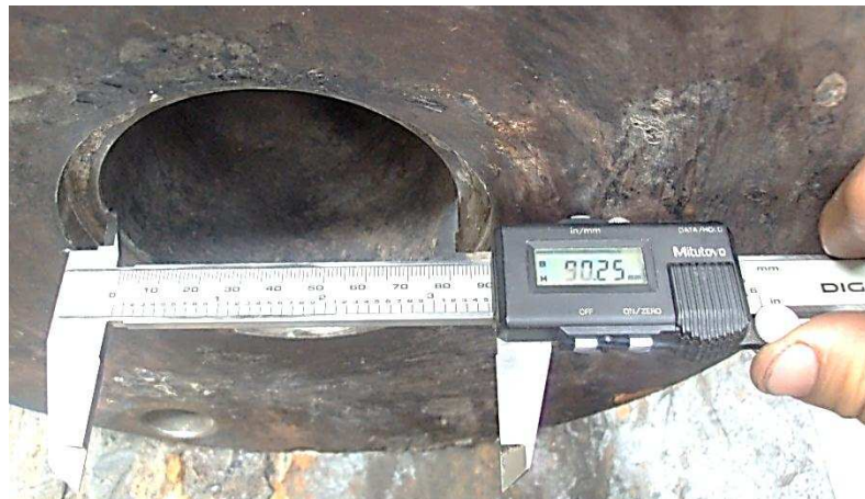
Figura 60. Medición del interior de la camisa
