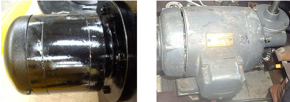
Figura 28. Motores jaula de ardilla auxiliares de la máquina extrusora
