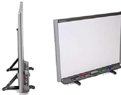
**2.4.2.3 Ultrasonido e infrarrojos.** Una **PDI de ultrasonidos e infrarrojos** consta de un dispositivo receptor y de un lápiz electrónico. El dispositivo receptor, añadido a una superficie de trabajo que se recomienda que sea blanca y lisa, permite que esta se convierta en una pizarra interactiva.
