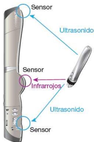
Como se puede observar en la figura 14, se indican las posiciones de los diversos sensores que utiliza una pizarra ultrasónica e infrarroja, en los extremos están ubicados los sensores ultrasónicos y en el centro el sensor infrarrojo.
