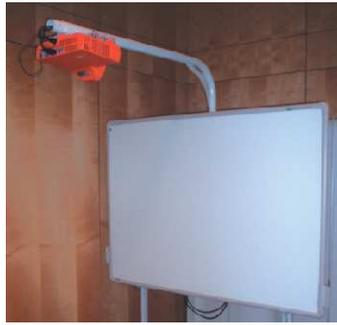
**2.4.2.2 Pasiva.** La superficie de una **PDI pasiva, táctil o resistiva** está formada por dos capas entre las que existe una cámara de aire. La capa exterior es blanda y flexible, de tal forma que al presionar sobre ella entra en contacto con la membrana interior, lo que provoca un impulso eléctrico que permite localizar el punto exacto sobre el que se desea actuar.
