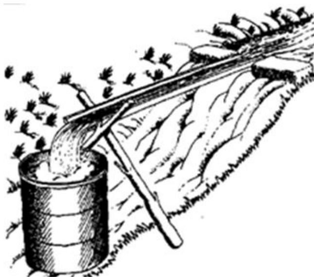
Figura 11. Medida del caudal usando un recipiente de capacidad conocida
