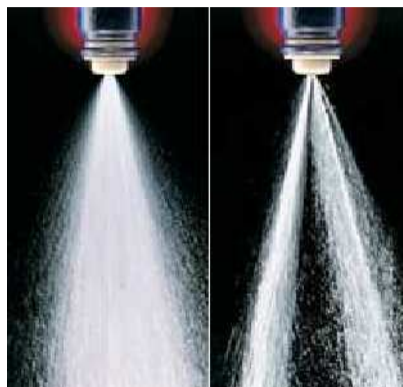
Figura 14. Atomización correcta e incorrecta de combustible
