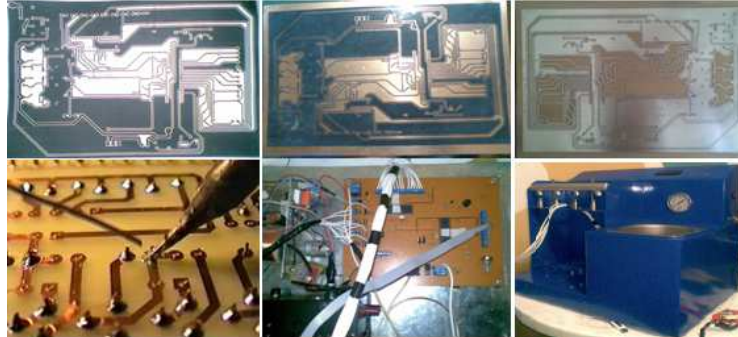
Figura 45. Armado de la placa electrónica
