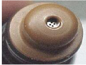
Figura 5. Inyector con válvula de disco
