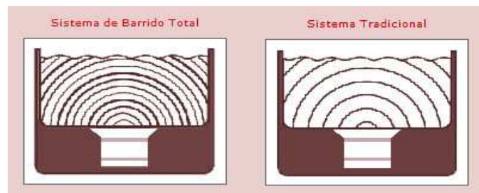
Figura 24. Influencia de la frecuencia ultrasónica en el líquido de limpieza
