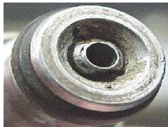
Figura 6. Inyector con válvula tipo bola
