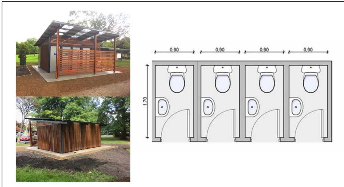
Ilustración 5-2: Referencia para el diseño de las nuevas letrinas a implementarse.
