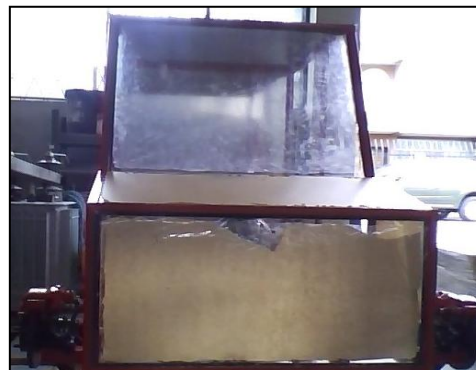
Figura 53. Acrílico colocado en la parte delantera de la maqueta.
