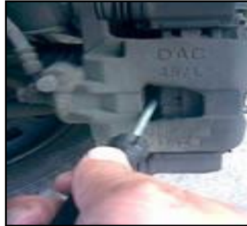
Figura 97. Proceso de retroceso de émbolo
