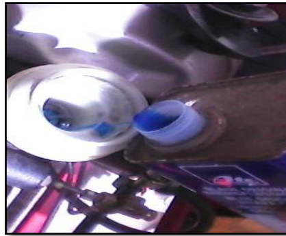
Figura 147. Llenado de líquido de freno
