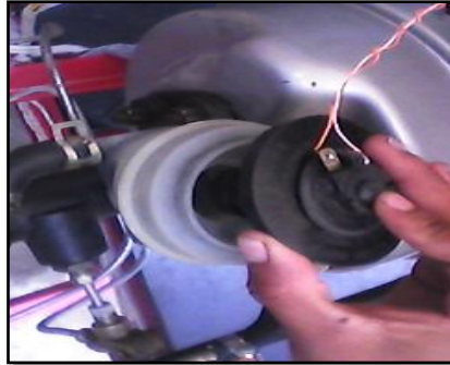
Figura 146. Montaje de conector eléctrico
