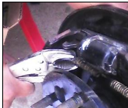
Figura 115. Ajuste de conjunto de zapatas
