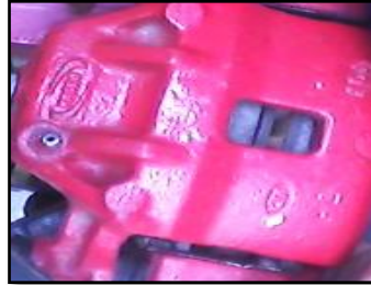
Figura 89. Visualización de pastilla en el interior de mordaza.
