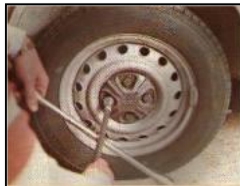
Figura 102. Retiro de las tuercas de sujeción de la rueda.
