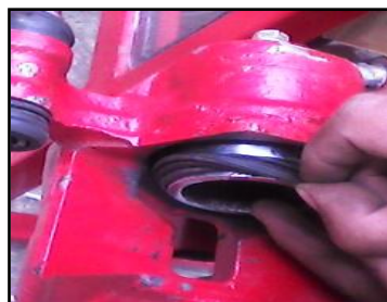
Figura 91. Revisión de retenes.
