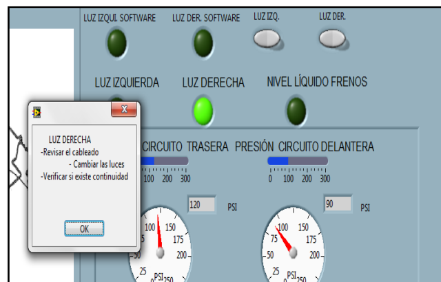
Figura 154. Mensaje de avería de luz posterior derecha
