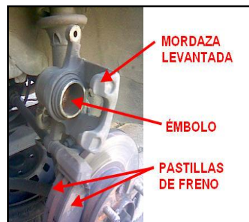
Figura 98. Desmontaje de pernos de sujeción de la mordaza
