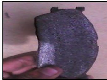
Figura 90. Inspección de pastilla.
