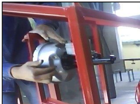
Figura 44. Colocación de servofreno.
