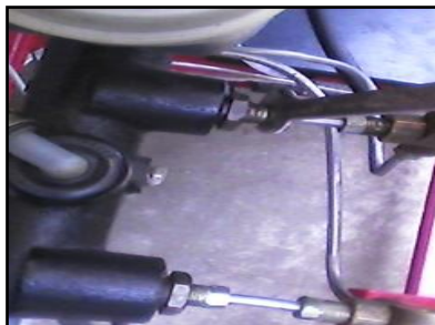
Figura 145. Ajuste de acoples en las tuberías.
