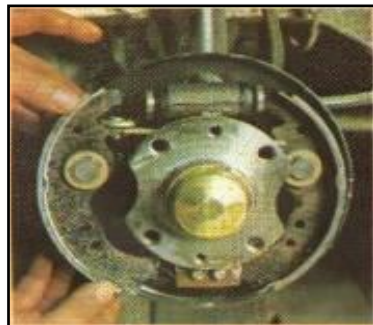
Figura 109. Extracción de zapatas
