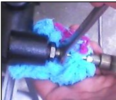
Figura 138. Colocación de trapo absorbente
