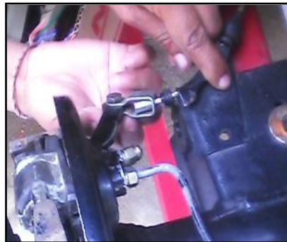
Figura 114. Conexión de cable de freno de mano
