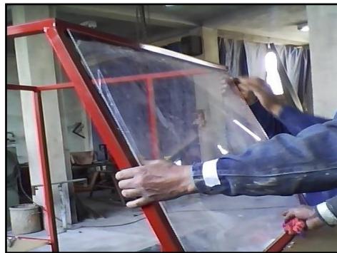
Figura 52. Colocando el acrílico en los parabrisas de la maqueta.
