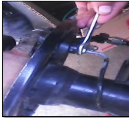
Figura 125. Montaje de tuberías de freno
