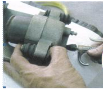
Figura 94. Extracción del pistón.
