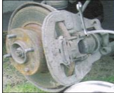
Figura 131. Colocación de llave en el tornillo de purga
