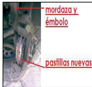
Figura 100. Proceso de montaje de pastillas de freno
