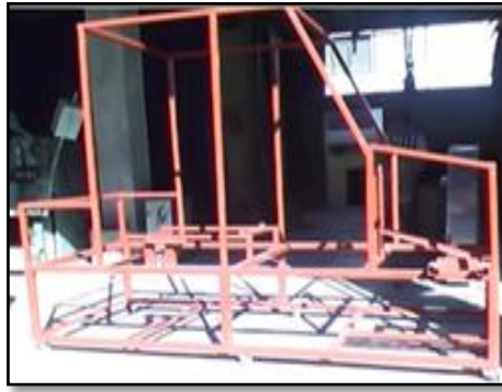
Figura 43. Pintura de la estructura de la carrocería.
