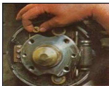
Figura 106. Retiro de perno de guía de zapatas.
