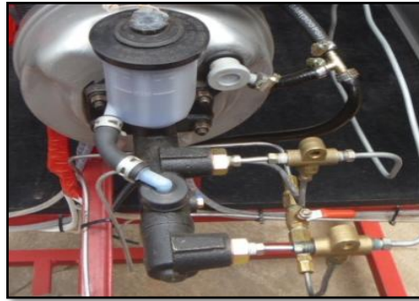
Figura 50. Conexión de cañería principal posterior.
