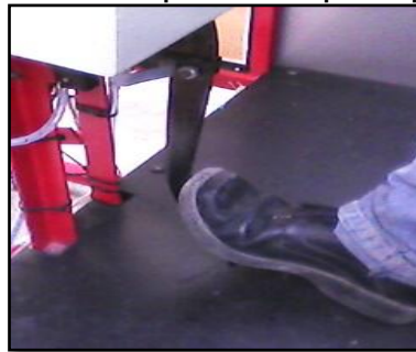
Figura 129. Proceso de oprimido de pedal para el purgado
