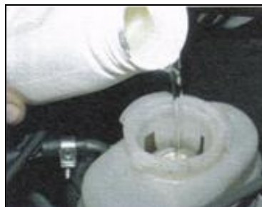
Figura 130. Llenado de líquido en el depósito
