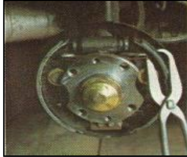
Figura 107. Desalojo de muelle superior de zapatas.
