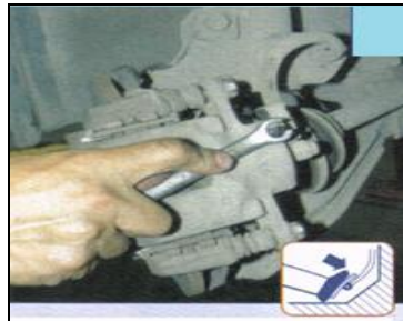
Figura 132. Desajuste de tornillo de purga
