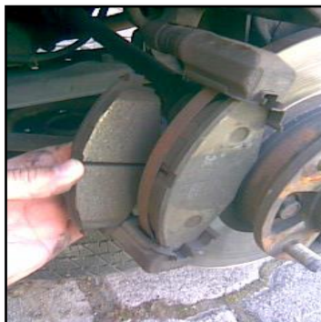
Figura 99. Retiro de pastillas
