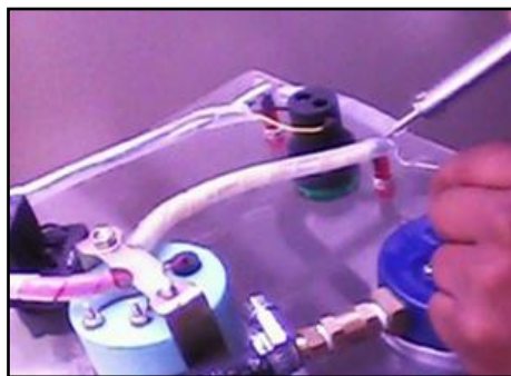
Figura 56. Unión con soldadura de los componentes electrónicos.
