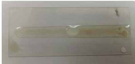
Ilustración 4-14: Ferrograma Golden Bear 10W30
