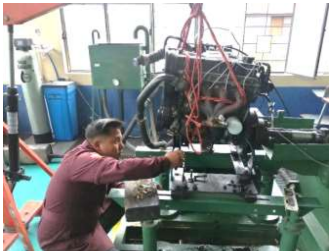
Ilustración 3-3: Desmontaje de motor
