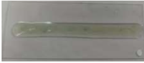
Ilustración 4-17: Ferrograma Top 1 20W50
