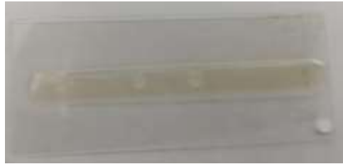
Ilustración 4-11: Ferrograma Top 1 10W30
