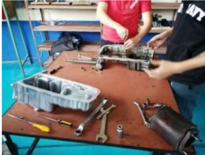
Ilustración 3-2: Cambio de cárter fisurado
