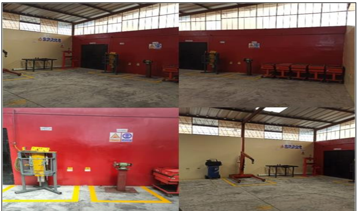
Ilustración 4-16: Estado del Área de Suspensión y Áreas de Trabajo del Taller Institucional Automotriz después de implementar las 5S de Kaizen y los sistemas de Gestión.
